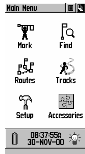
Menú Principal con iconos de funciones, alimentación, fecha/hora y ventana de estado de la luz de fondo
